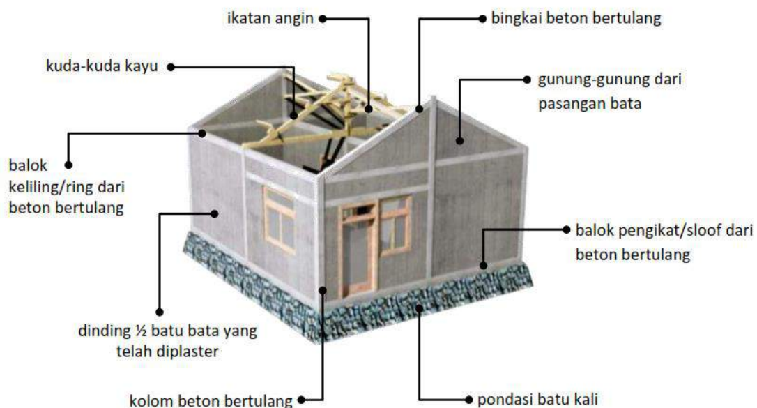
Gambar II.360 Struktur Bangunan Rumah Tinggal Tunggal
