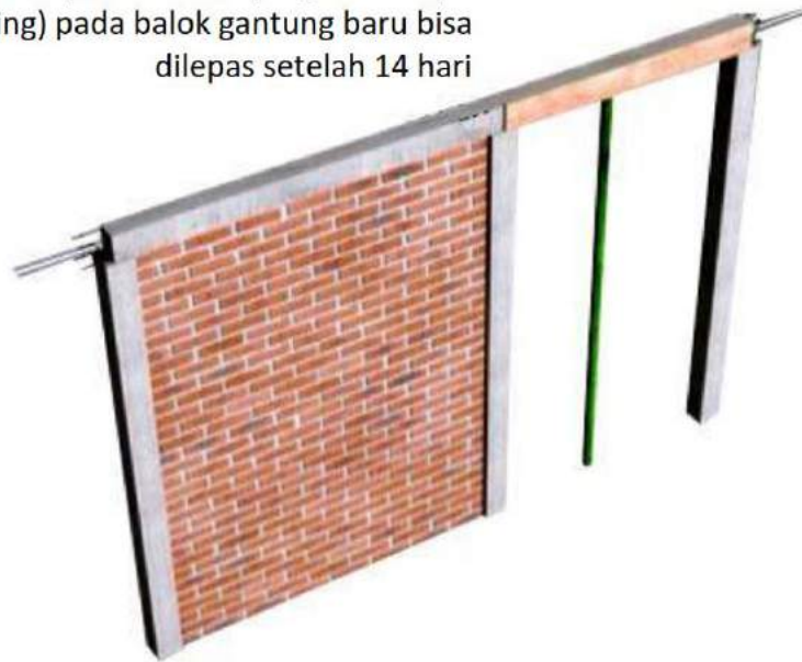
Gambar II.421 Pelepasan Cetakan/ Bekisting
