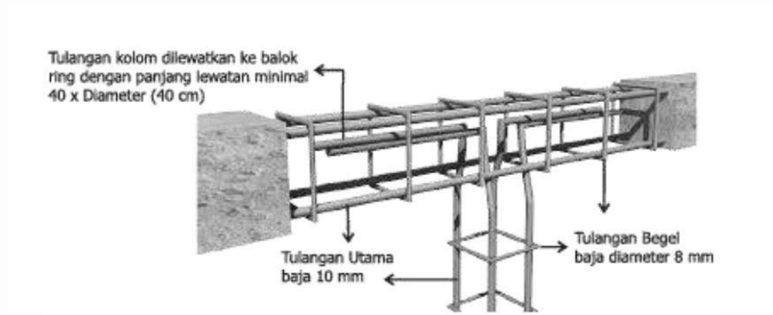
Gambar II.407 Hubungan Anatar Kolom dengan Balok Keliling/ Ring
