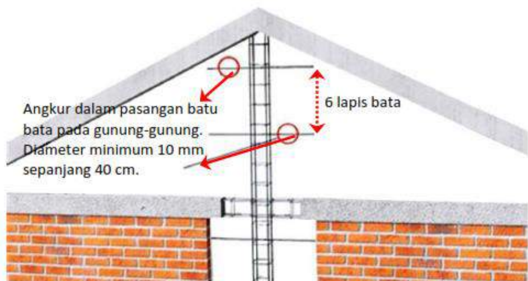
Gambar II.411 Hubungan Angkur Pada Gunung-Gunung/ Ampig
