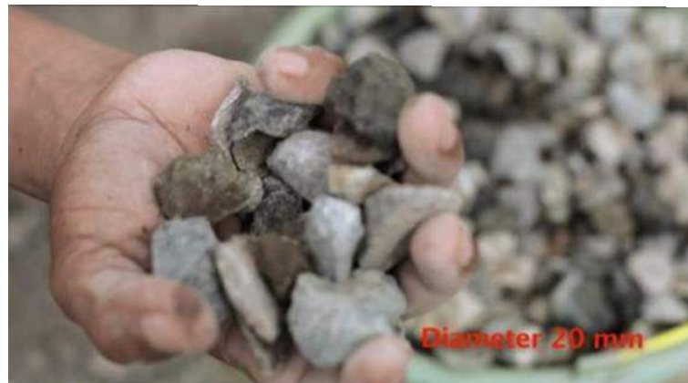
Gambar II.364 Diameter Kerikil Yang Baik Untuk Campuran Beton
