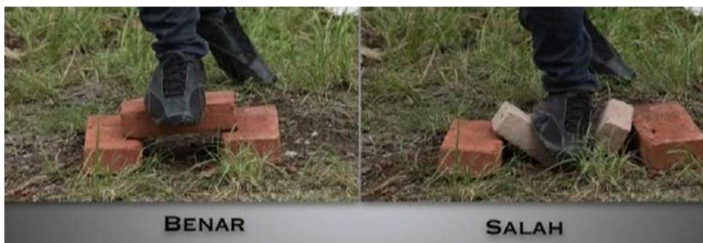
Gambar II.372 Pengujian Sederhana Kekuatan Batu Bata
