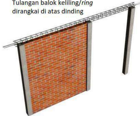
Gambar II.419 Perangkaian Tulangan Balok Keliling/ Ring Di Atas Dinding
