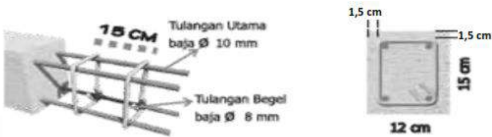
Gambar II.380 Dimensi Tulangan Balok Keliling/ Ring
