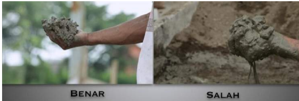
Gambar II.362 Pengujian Sederhana Dengan Meletakkan Campuran Beton di Tangan
