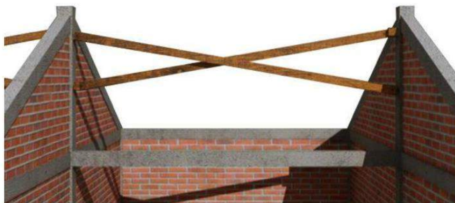
Gambar II.394 Ikatan Angin Sebagai Pengikat Antar Gunung-Gunung/ Ampig
